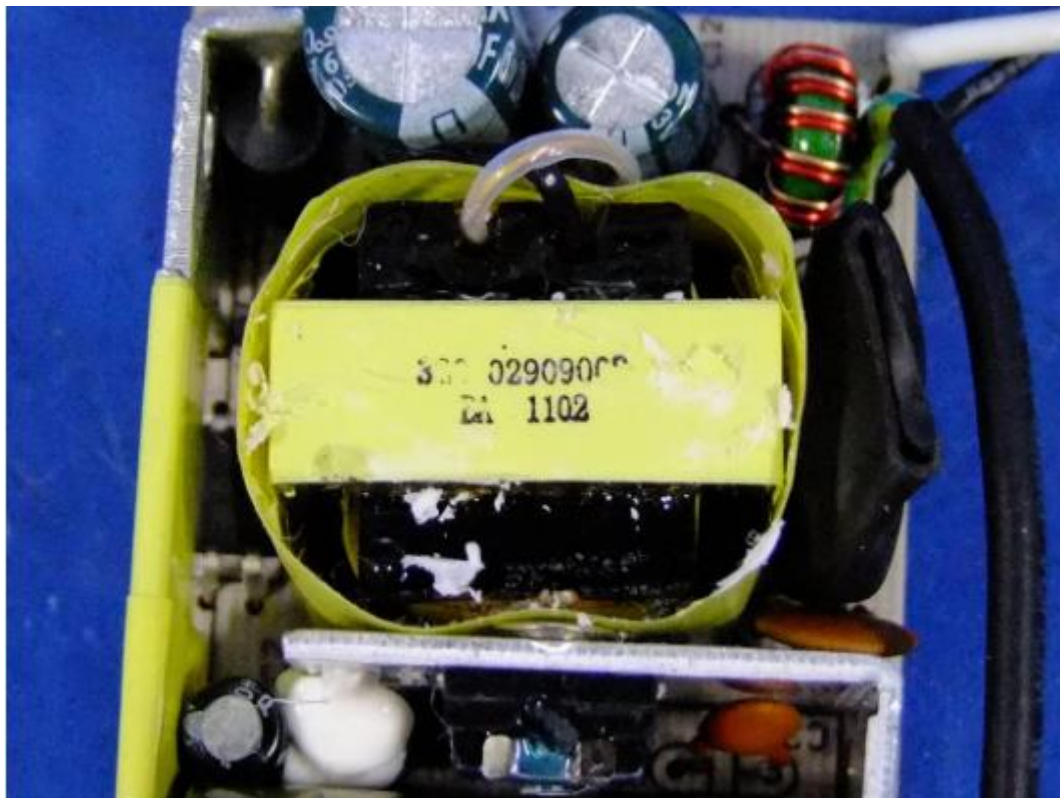
变压器照片(变压器上标注型号 GT-3048001)
