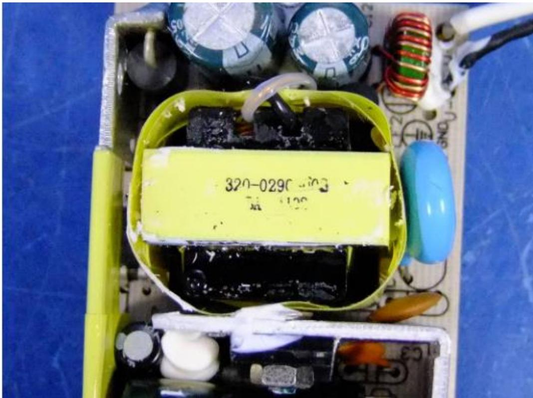
变压器照片(变压器上标注型号 GT-3048001)
