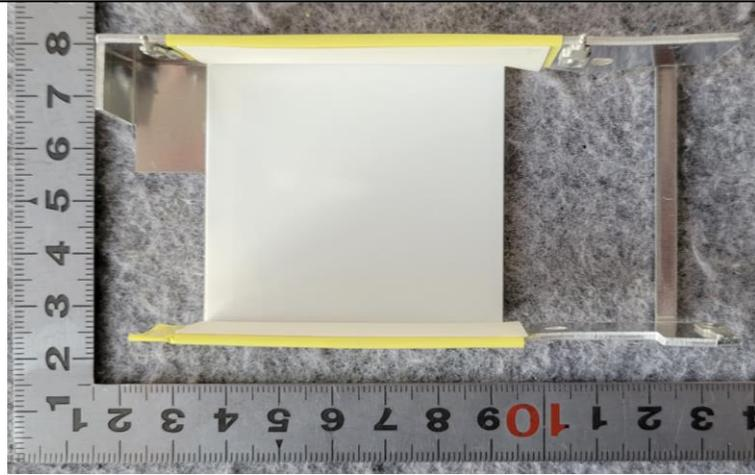
内部结构 (初级部分采用符合绝缘要求的绝缘垫片和2层绝缘胶带)
