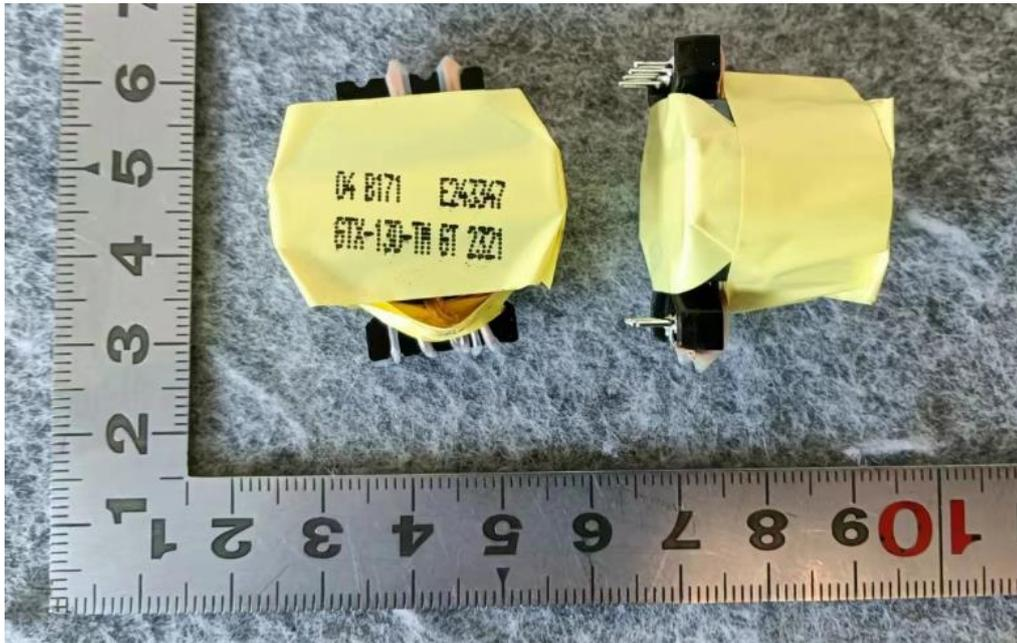
隔离变压器T1 (型号: 04B171)
