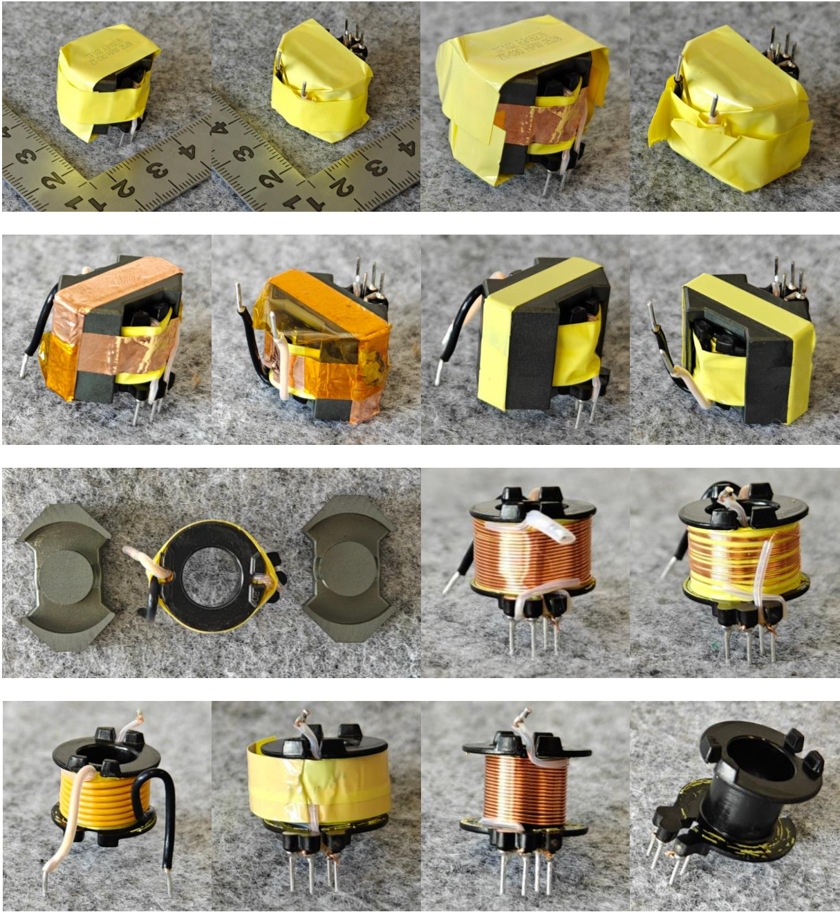
变压器拆解图 (型号TF102)
