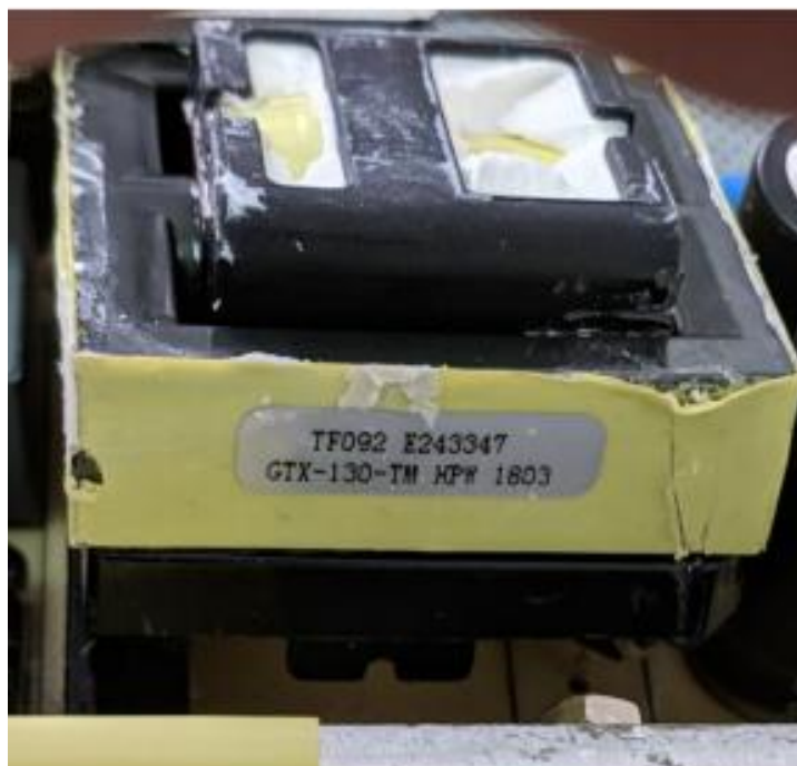
变压器 (GTM961600P18054-T2) (型号: TF092, 制造商为HAOPUWEI)
