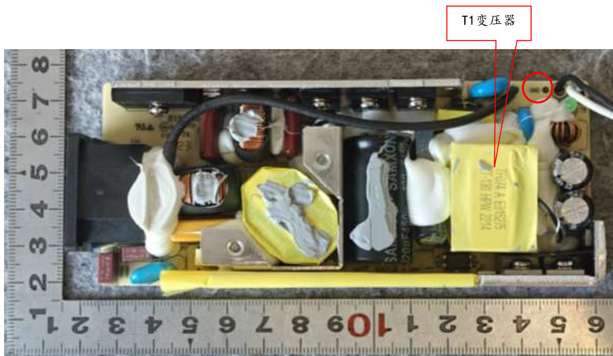
内部结构 (地线也可接到红圈中端子处) (本次变更)
