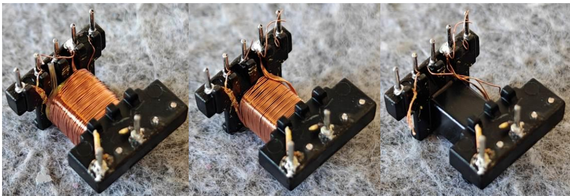
T1隔离变压器拆解图 (型号: TF035, HPW代表制造商HAOPUWEI)
