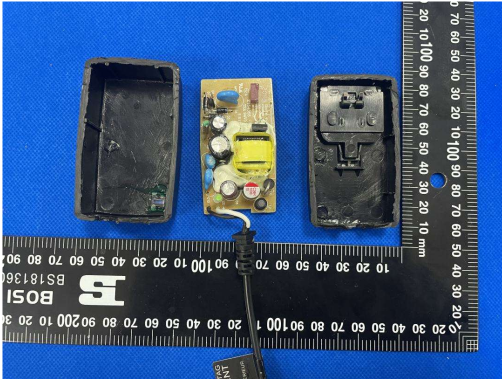
PCB 板零件面正視圖
