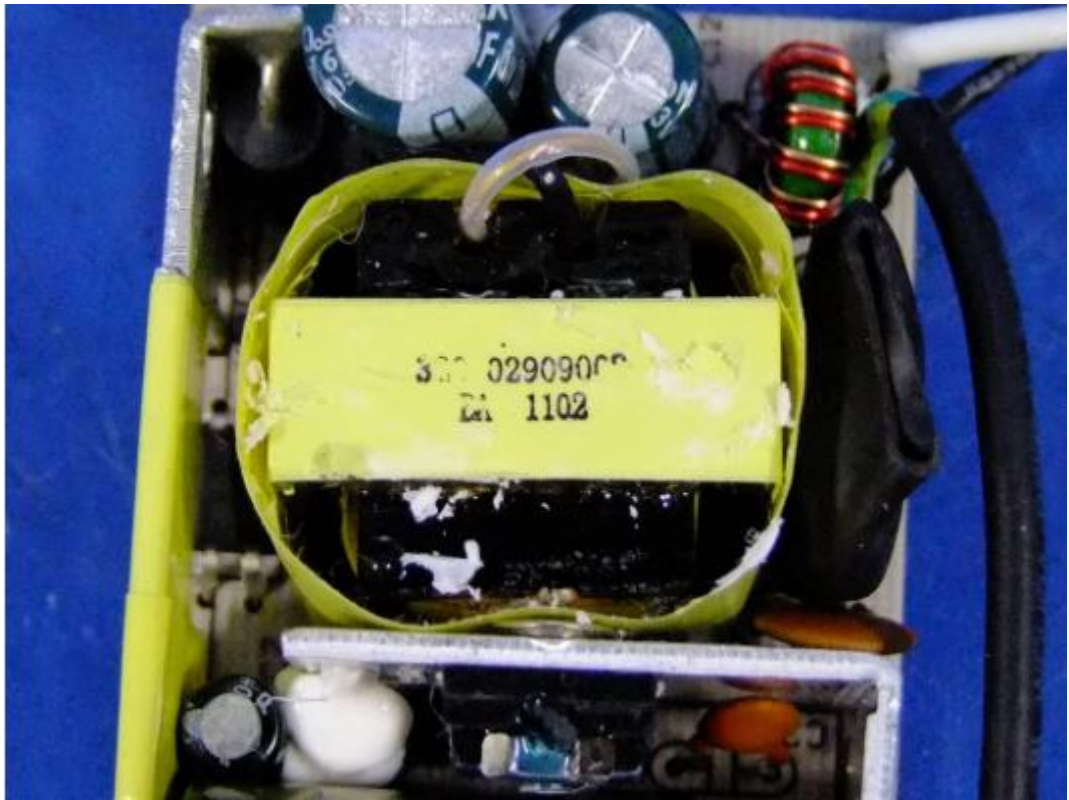
变压器照片(变压器上标注型号 GT-3048001)
