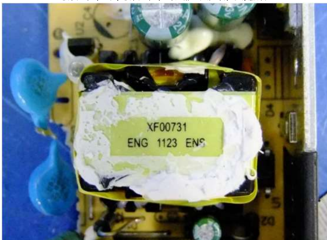
变压器 (ENG 代表 ENG Electric Co., Ltd.)
