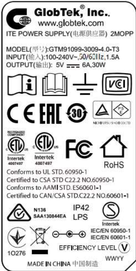
GTM91099-3009-4. 0-T3铭牌（其余铭牌仅型号规格不同）
