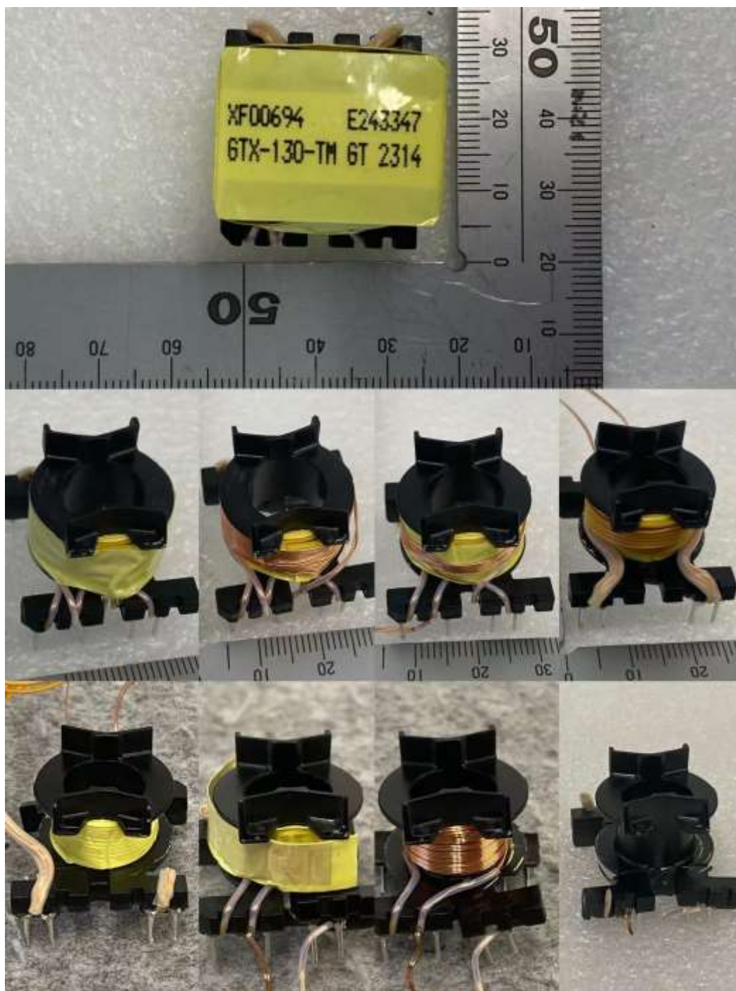
隔离变压器T1 (型号: XF00694, GT代表制造商GlobTek)
