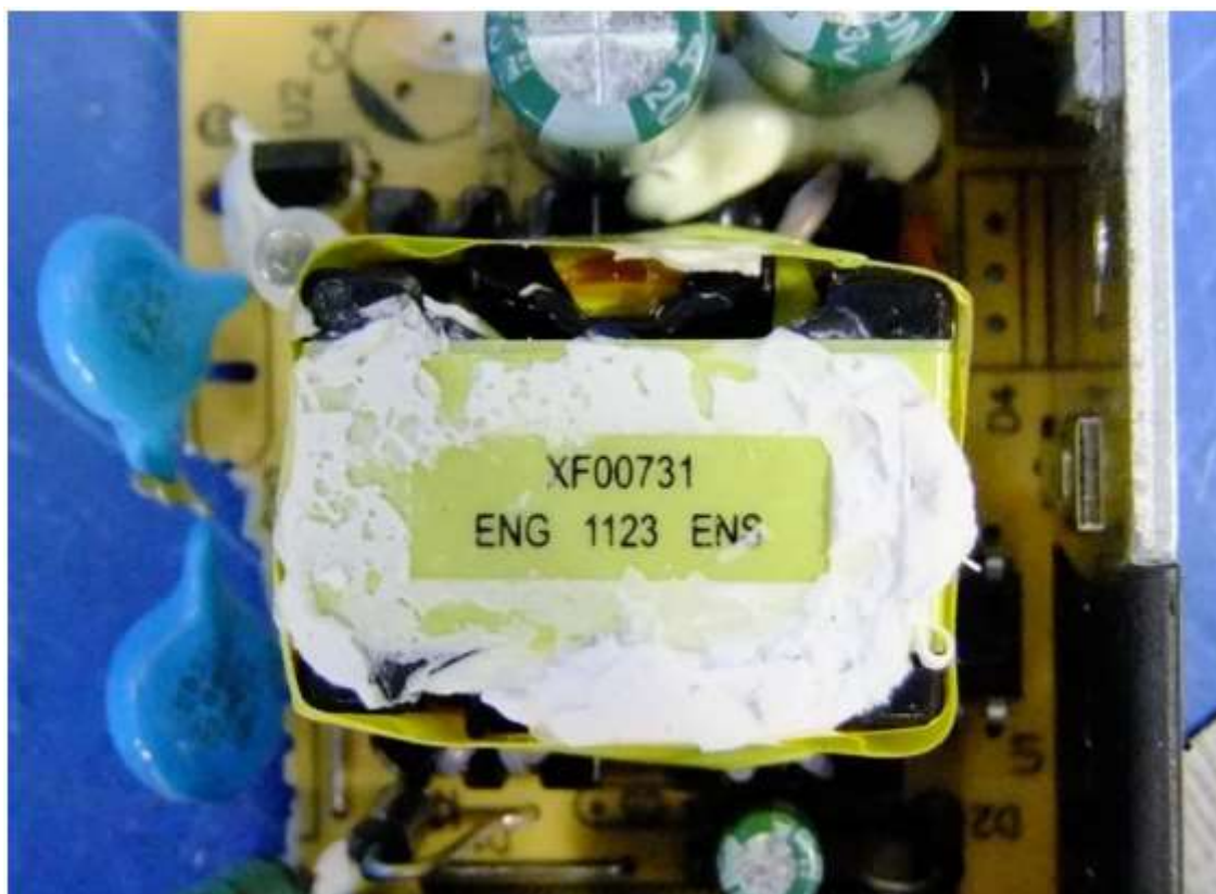
变压器 (ENG 代表 ENG Electric Co., Ltd.)
