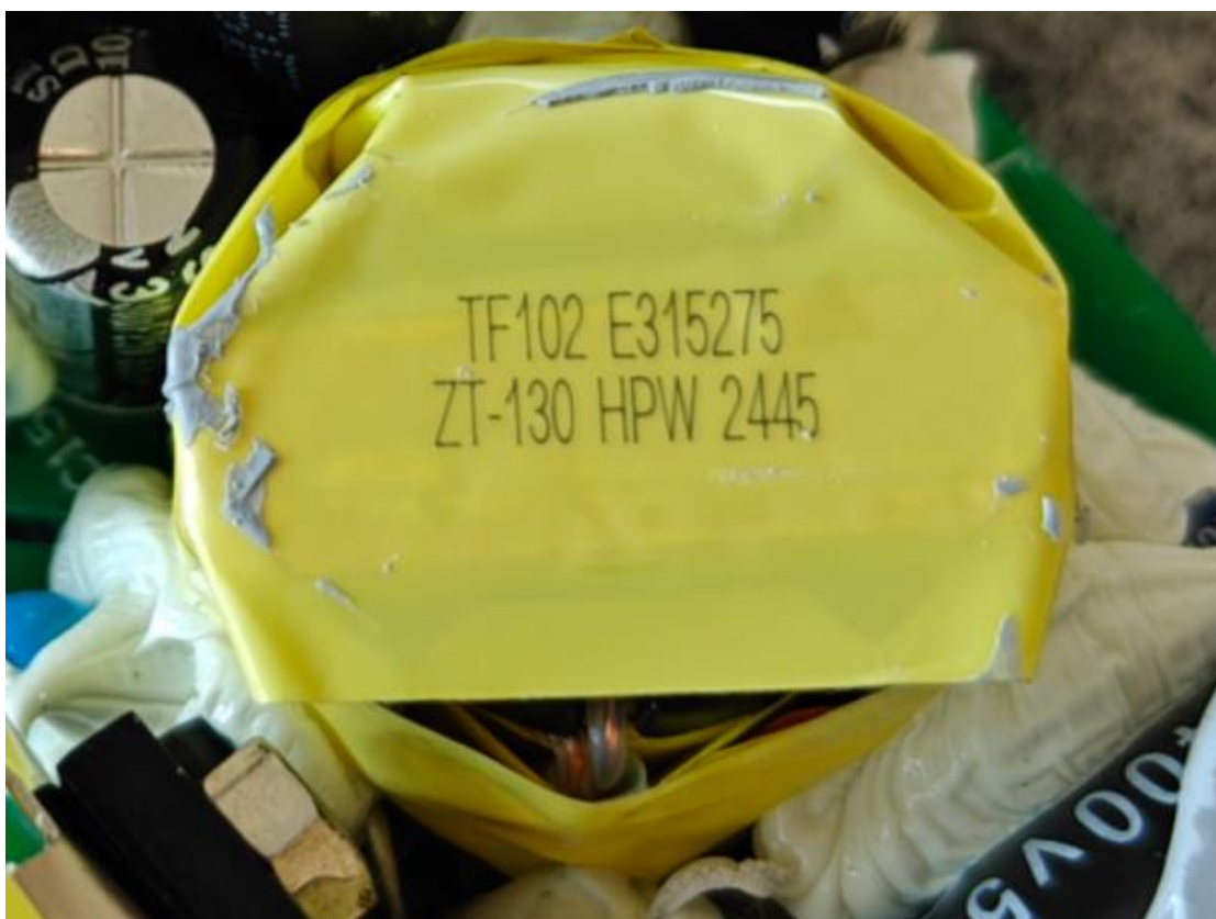
变压器标识 (型号TF102, HPW代表制造商HAOPUWEI) (GTM96181系列)
