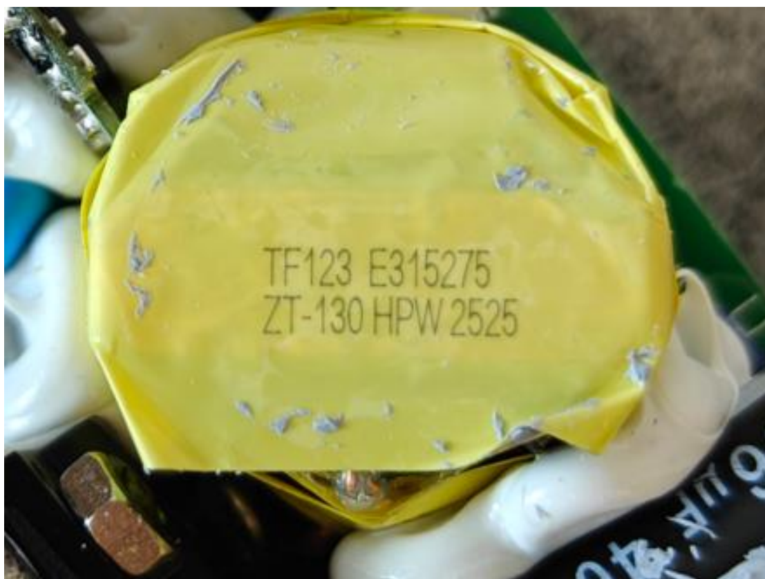
变压器标识 (型号TF123, HPW代表制造商HAOPUWEI) (GTM96183系列)
