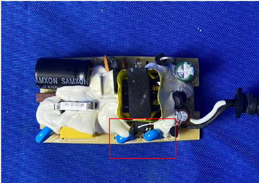
内部结构2 (本次新增, 相比与原已认可内部结构, 仅初次级间增加CY2电容与CY1串联)
